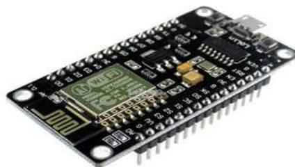
Figure 8. The ESP8266 WIFI-Module
